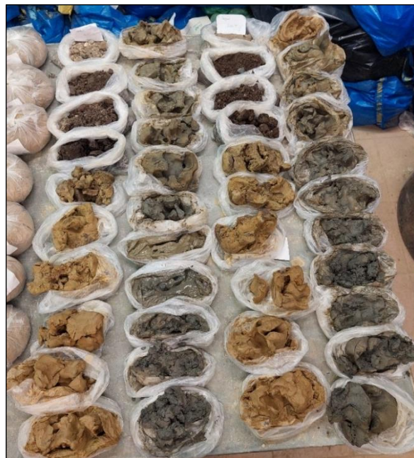
8. ábra – A darupálya nyomvonalában mélyült kiegészítő fúrásokból vett zavart talajminták (201F-202F)
