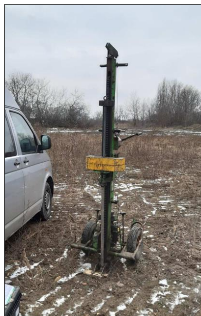
7. ábra – A területen korábban végzett nehéz verőszondázás
