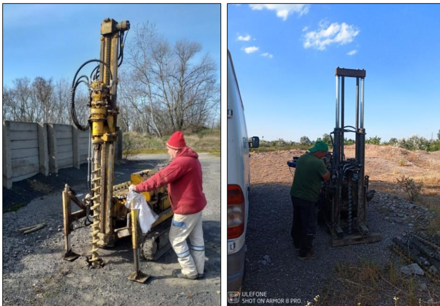
5. ábra – A területen végzett talajmechanikai fúrás Sedidril-140 (bal) és Kubota típusú fúróberendezéssel (jobb)
